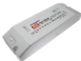
Alimentation led avec correction du facteur de puissance dans un boîtier plastique IP20 90~264 VCA/24VDC. Protection contre les courts-circuits, les surcharges et les surtensions. Rendement de ±89%.
