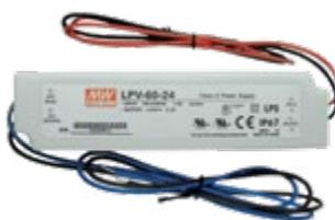
Alimentation led de classe II avec correction du facteur de puissance dans un boîtier plastique IP67 90~264 VCA/24VDC. Protection contre les courts-circuits, les surcharges et les surtensions. Câbles de raccordement pré-assemblés de 30cm. Rendement de ±88%.
