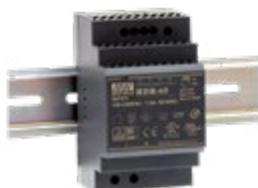
Alimentation de classe II pour montage sur rail-DIN dans des tableaux électriques domestiques 185~264VCA/24VDC. Protection contre les courts-circuits, les surcharges et les surtensions. Sortie CC réglable et limitation de courant. Rendement de  $\pm 90\%$ .
