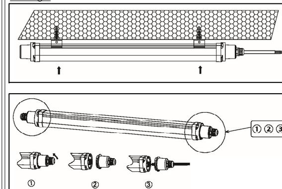
Percez deux trous de 6 mm dans le plafond/mur où vous souhaitez installer l'appareil. La distance entre les supports de montage vous pouvez choisir. Montez les supports de montage avec les vis et les chevilles fournies. Enclenchez le luminaire dans les supports de montage en le poussant dans les clips de montage. Assurez-vous que les clips s'encloignent bien. Si vous le souhaitez, les supports de montage peuvent être fermement ancrés avec les boulons fournis M4x60 + écrou.
