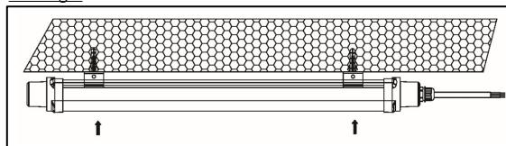
Boor twee gaten van 6mm in plafond/muur op de plaats waar u het toestel wilt installeren. De afstand tussen de montagebeugels is vrij te kiezen. Monteer de montageklemmen met de meegeleverde schroeven en pluggen. Klik het armatuur in de montagebeugels door het in de montageklemmen te duwen. Zorg ervoor dat de klemmen vastklikken. Indien gewenst kunnen de montagebeugels stevig verankerd worden met de meegeleverde bouten M4x60 + moer.
