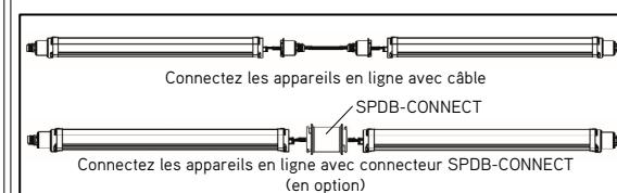
Speedy Basic peut être facilement connecté à l'aide de la pièce d'accouplement SPDB-CONNECT (à commander séparément).
