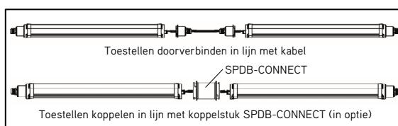
Toestellen doorverbinden in lijn met kabel
