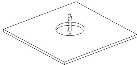
4. Pressez les pinces latérales pour insérer le spot dans l'ouverture du plafond puis assurez-vous que le spot est fermement maintenu dans le plafond.
